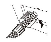
%FEP管の**先端が確実に止水材に埋没するまで**差し込みます。
