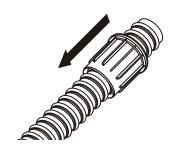
③FEP管を側壁の外側より内側へ入れ マウスを差し込みます。
