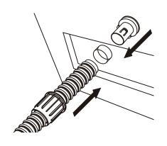
④マウスを内側壁面に密着させて、 可能な限り外側壁面の近くで、 ソケットをはめ込みます。
